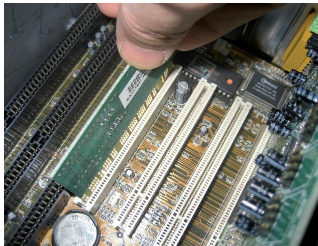
**Paso 3.** Nos aseguramos de que la tarjeta quede bien conectada presionándola contra la placa base y fijando el tornillo lateral para evitar que se mueva.
