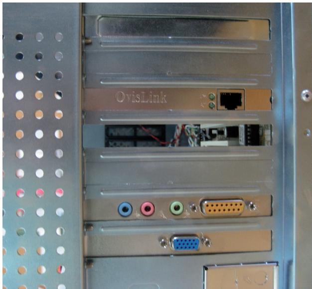
**Paso 5.** Encendemos el ordenador y automáticamente nos detectará el **nuevo hardware**. Windows XP dispone de una amplia base de controladores y seguramente instale la nueva tarjeta de red, sin que tengamos que introducir el disco con los *drivers*. Si el sistema operativo nos pide los *drivers*, introducimos el disco en la disquetera y seguimos los pasos del asistente para agregar o actualizar hardware.
