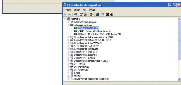
**Paso 6.** Ya tenemos los *drivers* instalados. Ahora conectaremos nuestro ordenador al *router* de la red mediante el cable de red. Si nuestra red es de tipo árbol, nos conectaremos a un *switch* o conmutador, pero esto no afectará a la configuración. Una vez conectados, se encenderá un LED en nuestra tarjeta de red.
