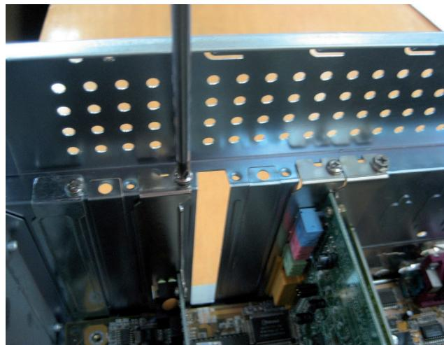
En la imagen superior tenemos abierta una segunda tapa metálica donde poder instalar nuevos dispositivos PCI: tarjeta capturadora de televisión, expansiones de puertos USB o Firewire, módem, etcétera.
