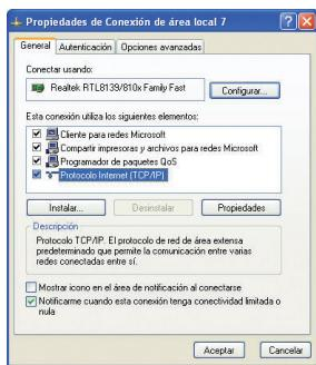
**Paso 9. Configuramos la dirección IP.** En este paso tenemos dos opciones: escribir nosotros mismos una dirección IP o permitir que el *router* nos asigne una automáticamente. Si elegimos esta segunda opción, debemos asegurarnos de que el *router* tiene el servidor DHCP activado. El servidor DHCP es una opción interna del *router* que le da una dirección IP a cada equipo que se conecta a él.
